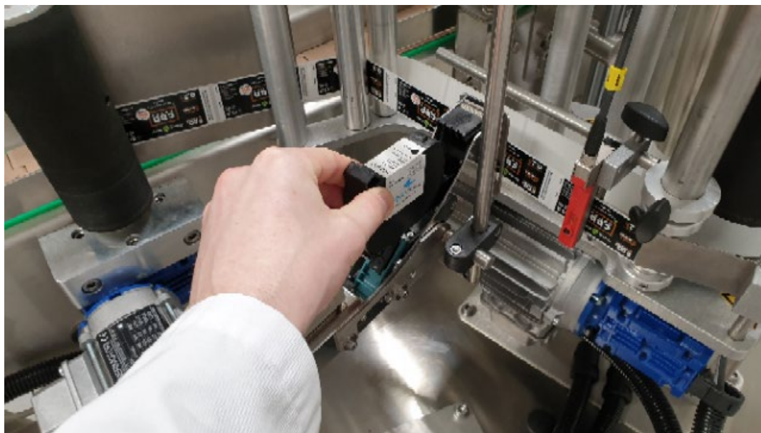
Slika 11: Vstavitve tiskalne kartuše
