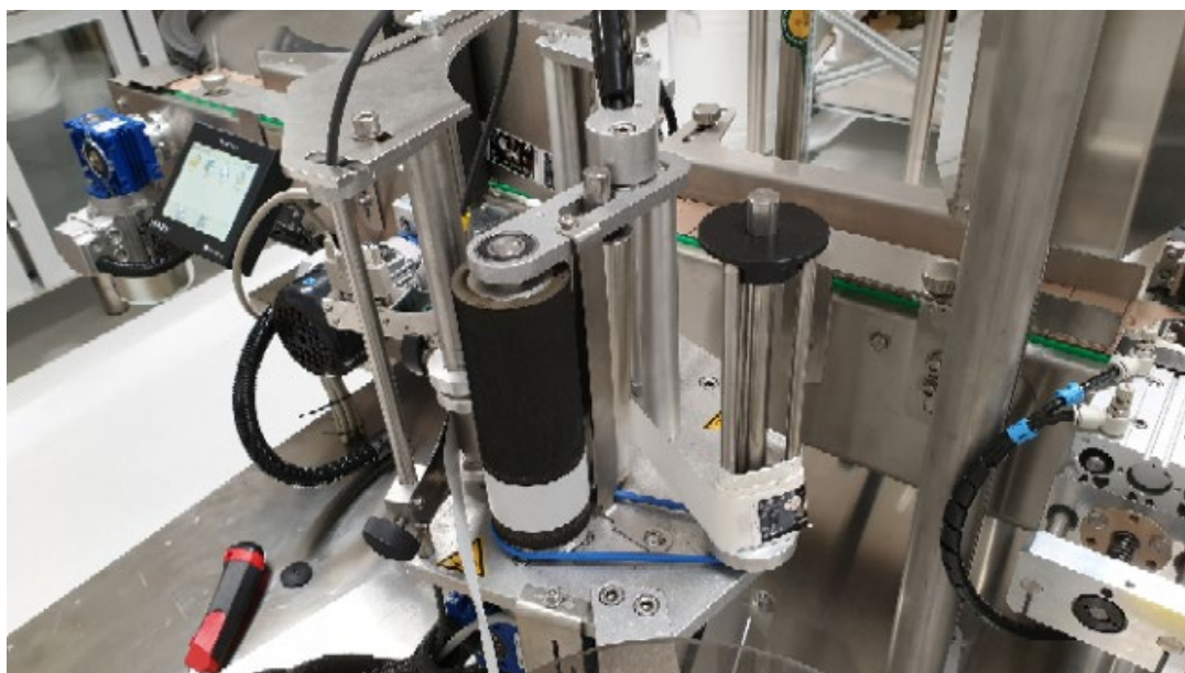
Slika 9: Primer napeljave traku za etikete
