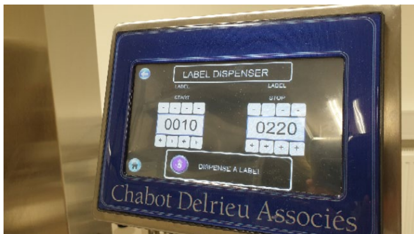
Slika 131: Uravnavanje časovnih zamikov za podajanje nalepk
