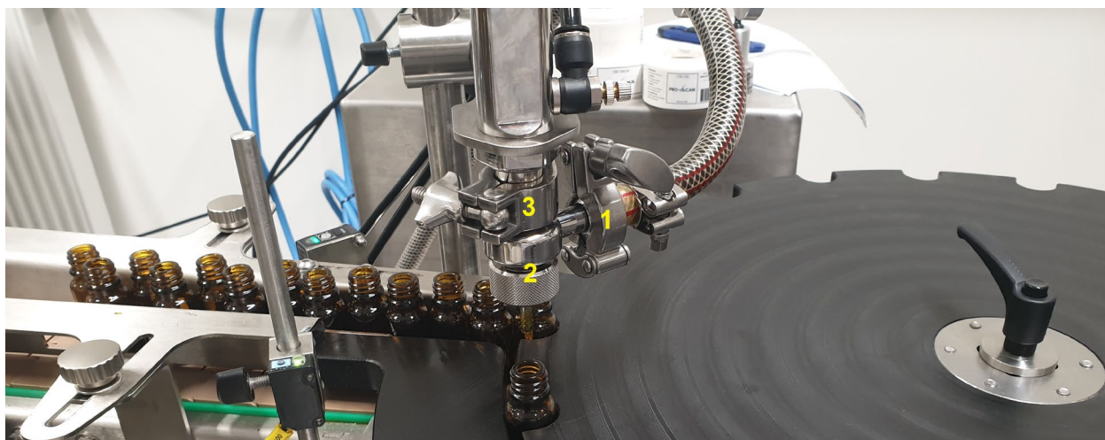
Slika 18: Zaporedje čiščenja polnilne glave
