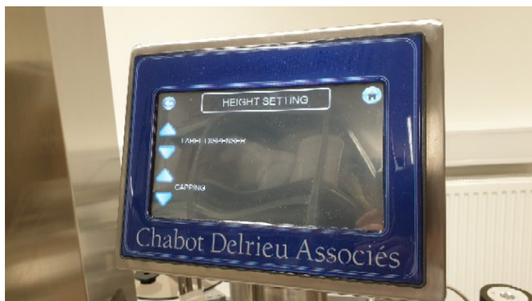
Slika 14: Nastavitev višine tiskalne glave in zapiralne glave
