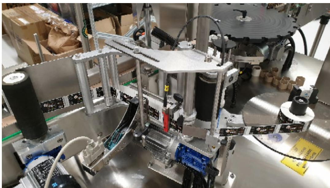
Slika 10: Primer napeljave traku za etikete
