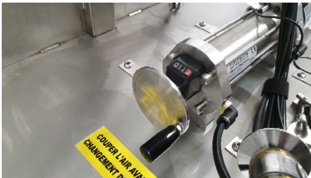
Slika 8: Ročka za nastavev hoda bata
