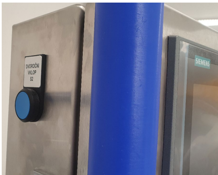
Slika 3: Levo stikalo za dvig pokrova.
